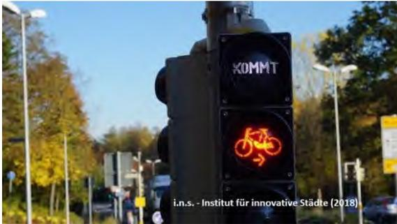
Abbildung 95: „Signal kommt“-Anzeige
