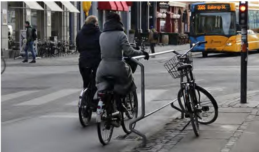
Abbildung 33: Auch kleine Aufmerksamkeiten wie diese Haltestangen mit Fußauftritt an Lichtsignalanlagen machen Radfahren angenehm.
