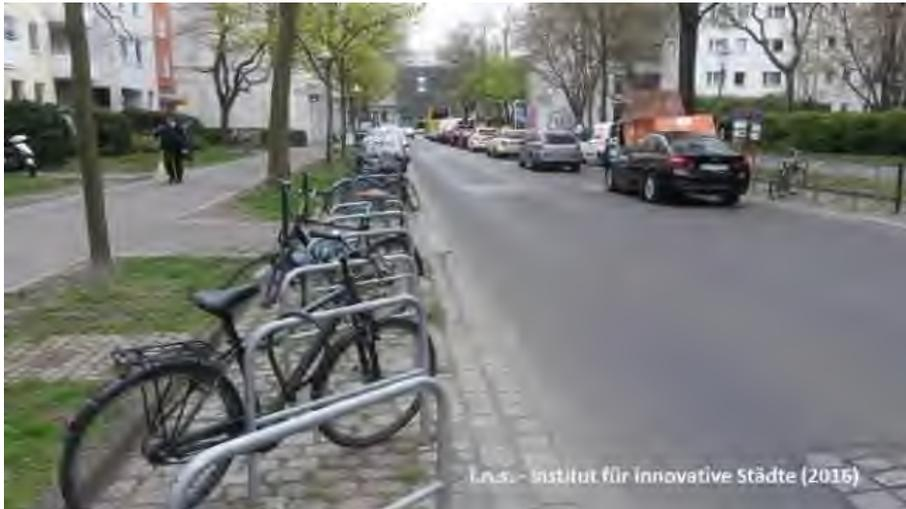
Abbildung 76: Anlehnbügel auf umgewidmeten Längsparkständen
