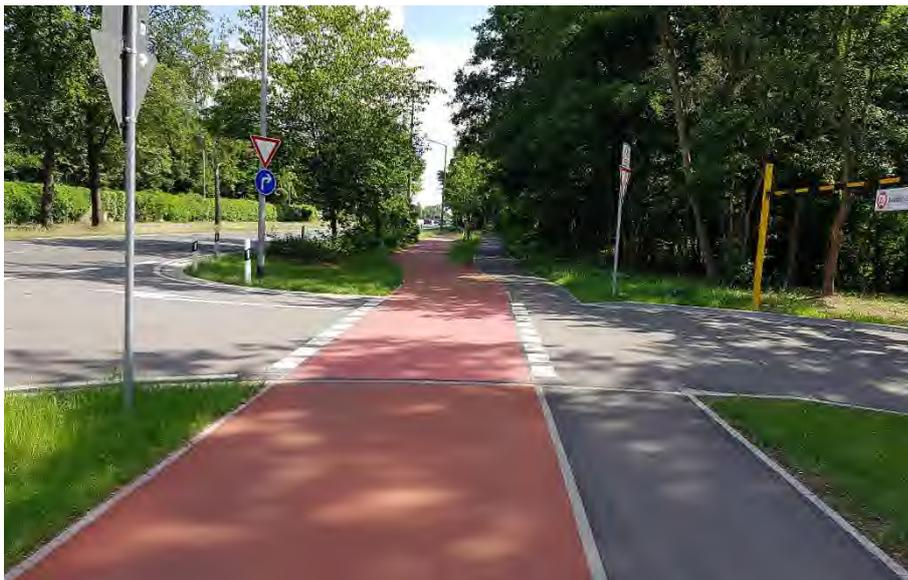
Abbildung 117: Radweg mit roter Asphaltdeckschicht
