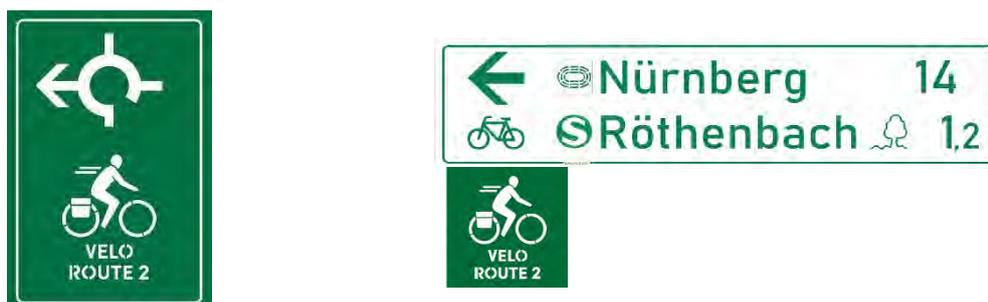
Abbildung 67: Nicht-amtliches Hinweisschild und Einschubplakette als Zusatz zur Radwegweisung nach dem FGSV-Standard
