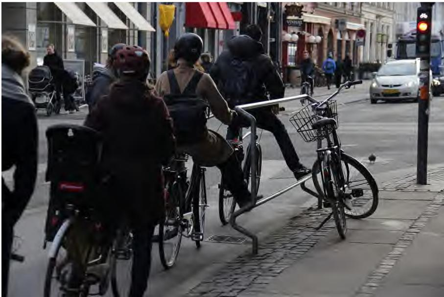
Abbildung 114: Ampeltrittbretter für Radfahrer an einer Lichtsignalanlage
