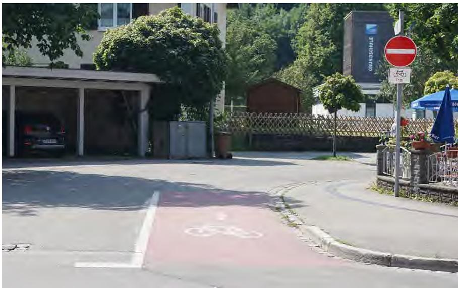
Abbildung 125: Öffnung einer Einbahnstraße für den Radverkehr in Gegenrichtung
