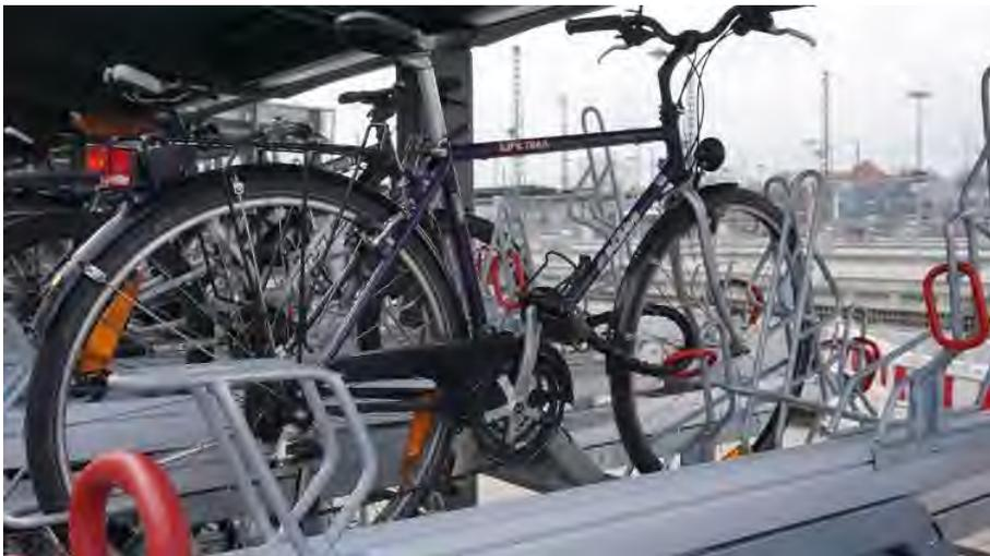
Abbildung 72: Radabstellanlage mit AnschlieÙsmöglichkeit des Fahrradrahmens
