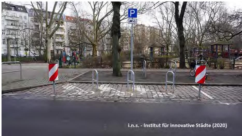
Abbildung 84: Lastenradstellplatz – hier mit kurzem Anlehnbügel
