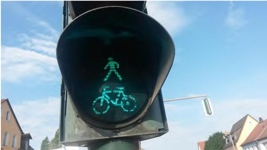
Abbildung 90: Bei der gemeinsamen Signalisierung von Fuß- und Radverkehr verlängert sich die Rotphase für Fahrradfahrer unnötig. Eine Alternative sind eigene Ampeln (Signalgeber) für den Radverkehr.
